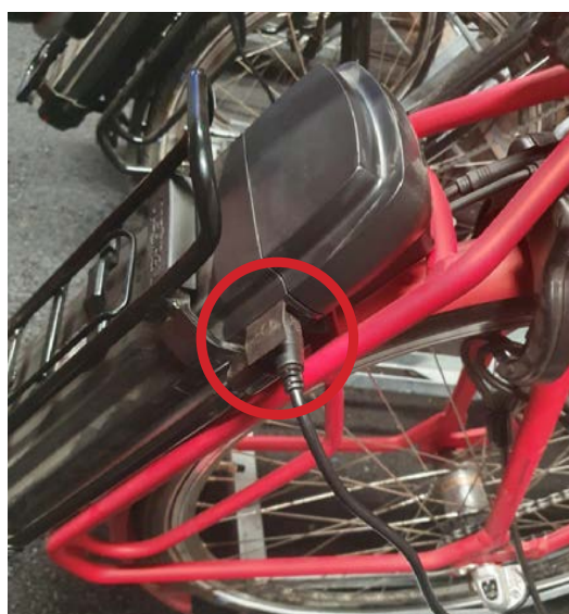
Här kopplas laddkabeln in i batteriet när du återlämnar cykeln.
