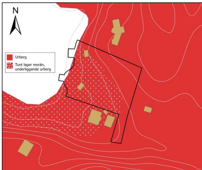
Figur 4. Kartan visar jordarter inom planområdet (svart). Ytor med rött är urberg och ljusblå prickar utgör ett tunt moräntäcke ovan urberg. Källa: SGU (2023).
