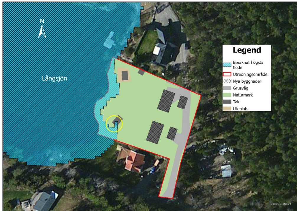
Figur 18. Beräknad högsta flöde enligt MSB i förhållande till planerad bebyggelse. Den gula cirkeln visar en potentiellt kritisk yta.
