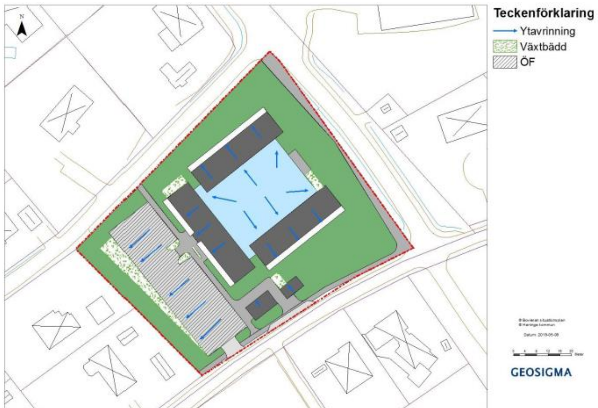
Figur 19. Illustration av föreslagna dagvattenlösningar för den planerade markanvändningen och förslag på avrinning, (ÖF = öppet förstärkningslager), Geosigma 2019-05-09.
