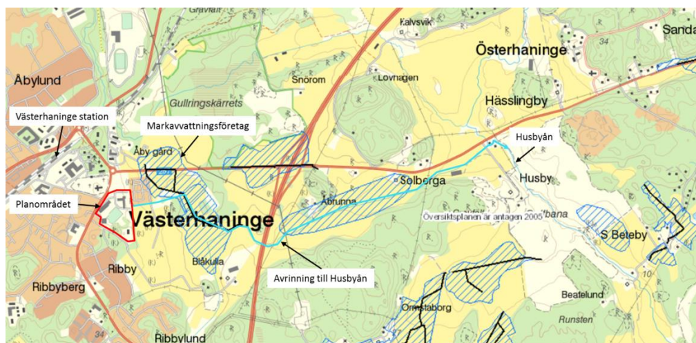
Figur 3:1 Översiktsbild över planområdet med avrinningen genom markavvattningsföretag till Husbyån. Källa: Länsstyrelsens WebbGIS.
