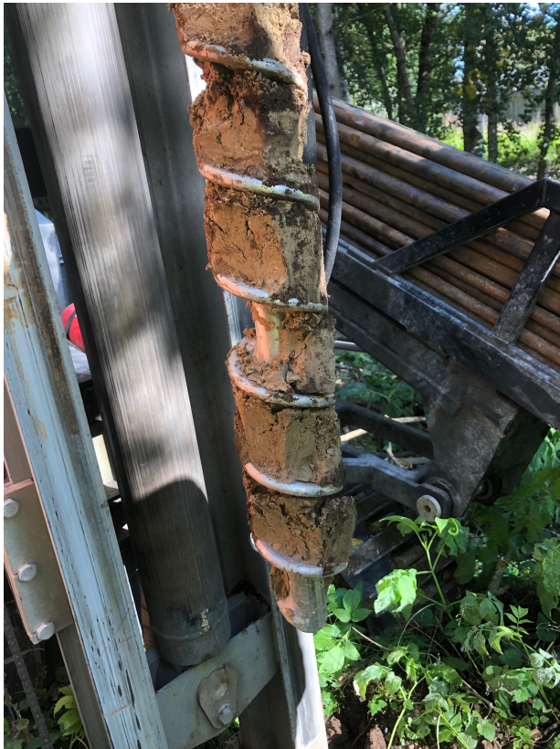
Figur 4. Samtliga prover togs direkt från skruvborren. Det yttre materialet skrapades bort för att minimera risken för kontaminering av ovanliggande jordlager då skruven drogs upp ur marken. Foto Geoveta.
