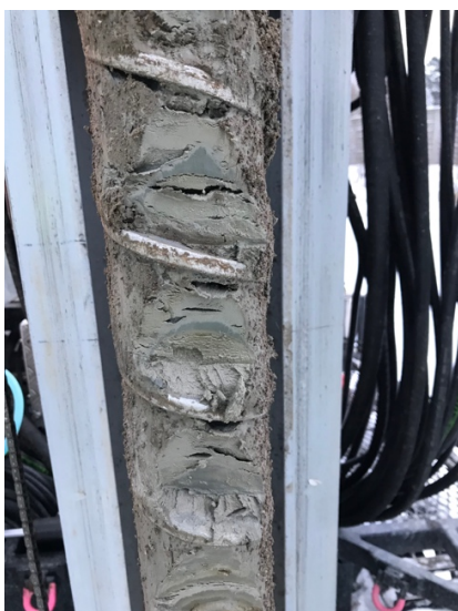
Figur 5. Samtliga prover togs direkt från skruvborren. Det yttre materialet skrapades bort för att minimera risken för kontaminering av ovanliggande jordlager då skruven dras upp ur marken. Foto Geoveta.
