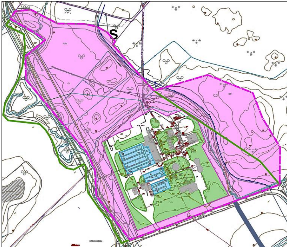
Figur 15. Rosa linje/område markerar avrinningsområdet och grön linje markerar planområdet. Olika ytor inom avrinningsområdet: rosa yta är skogs- och naturmark, grön yta är gräsyta, blå yta är bassänger, grå yta är tak och resterande yta är asfaltyta.
