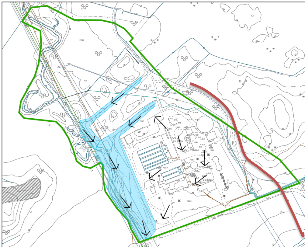
Figur 18. Rinnvägar vid extrema regn markerade med svarta pilar och översvämningsyta markerat med blått. Röd linje visar avskärande dike som leder till Vitsån.
