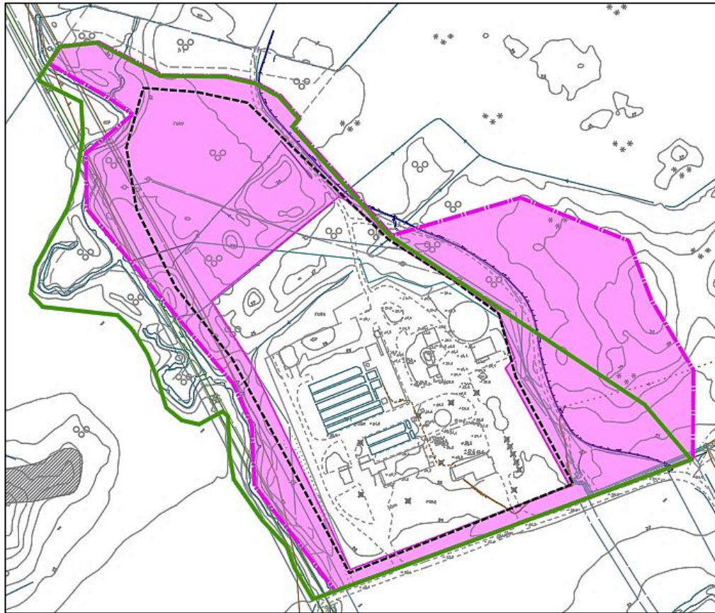
Figur 17. Rosa linje/område markerar avrinningsområdet och grön linje markerar planområdet. 60% av området inom den svarta streckade linjen antas i framtiden bli hårdgjord yta.
