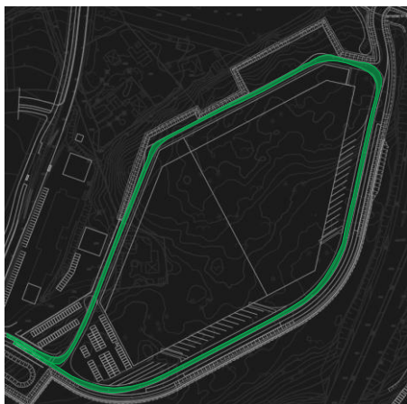
Figur 44. Område 1 – Kontroll av körspår för rundkörning (i grönt), typfordon A/AB-Dubbel
