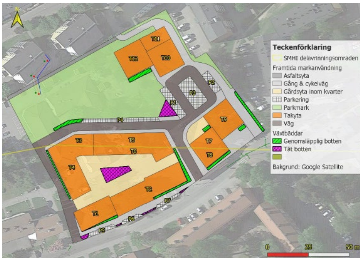
Figur 27. Dagvattenutredningens förslag på princip för dagvattenhantering inom planområdet. Exempel på placering av växtbäddar med en reglervolymsmäktighet om 0,1 m, en funktionell mäktighet om 1,0 m (0,5 m för innergården), och porositet om 30%, för att uppfylla erforderlig utjämningsvolym för respektive delavrinningsområde. Illustration: Geosigma (2020).
