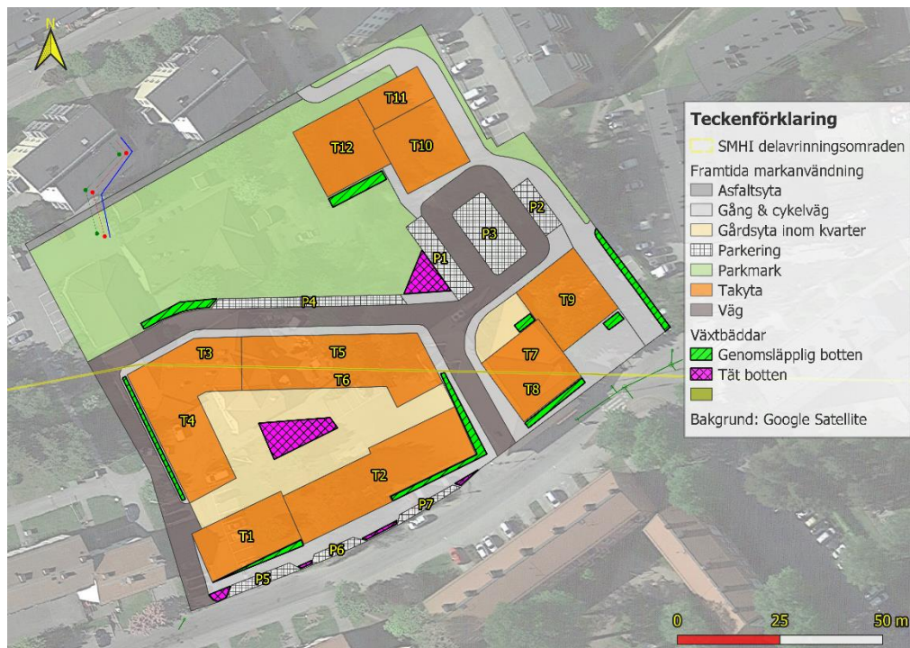
Figur 7:3. Exempel på placering av växtbäddar med en reglervolymsmäktighet om 0,1 m, en funktionell mäktighet om 1,0 m (0,5 m för innergården), och porositet om 0,3, för att uppfylla erforderlig utjämningsvolym för respektive delavrinningsområde.
