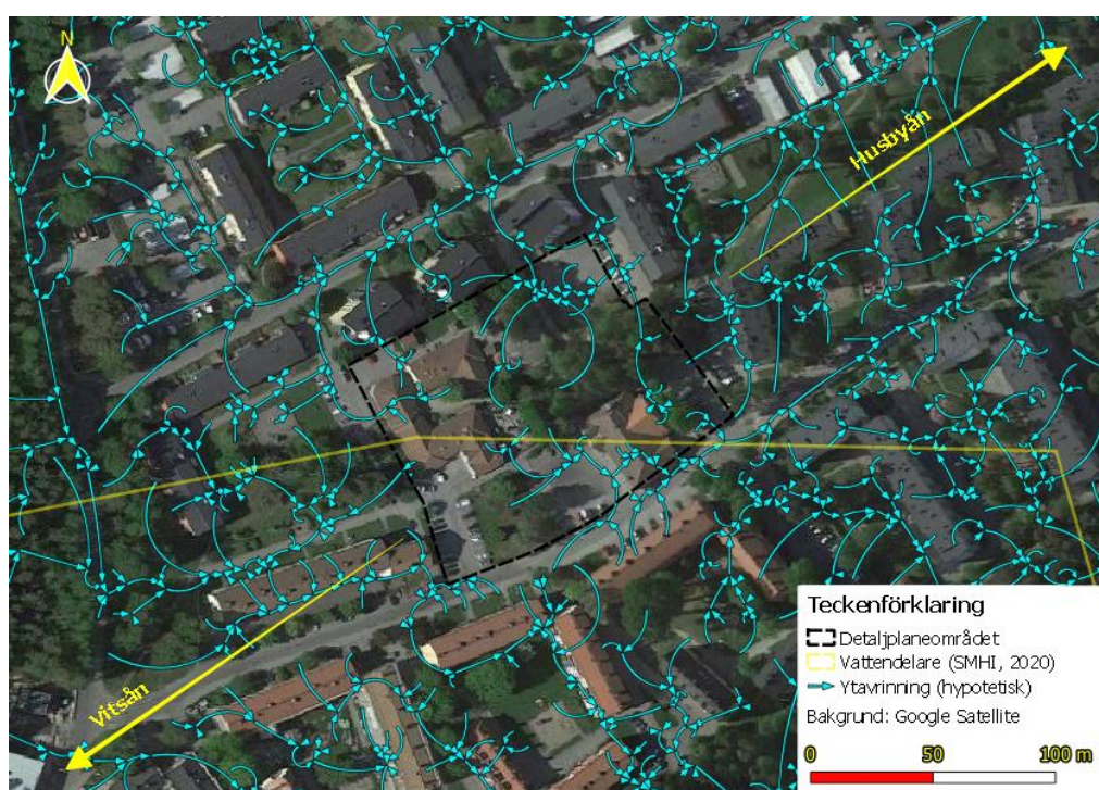
Figur 3:6. Hypotetisk ytvattendränning inom detaljplaneområdet med omnejd baserat på markytans topografi (grid 2+; Lantmäteriet).
