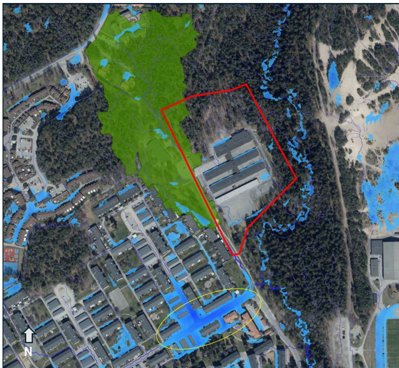
Figur 22 lågpunkt i söder markerad med gul ellips. Vid yttlig avrinning är det främst vatten från avrinningsområde 2 (grönt fält) som rinner till lågpunkten. Bild från dagvattenutredningen (Funkia, 2024).
