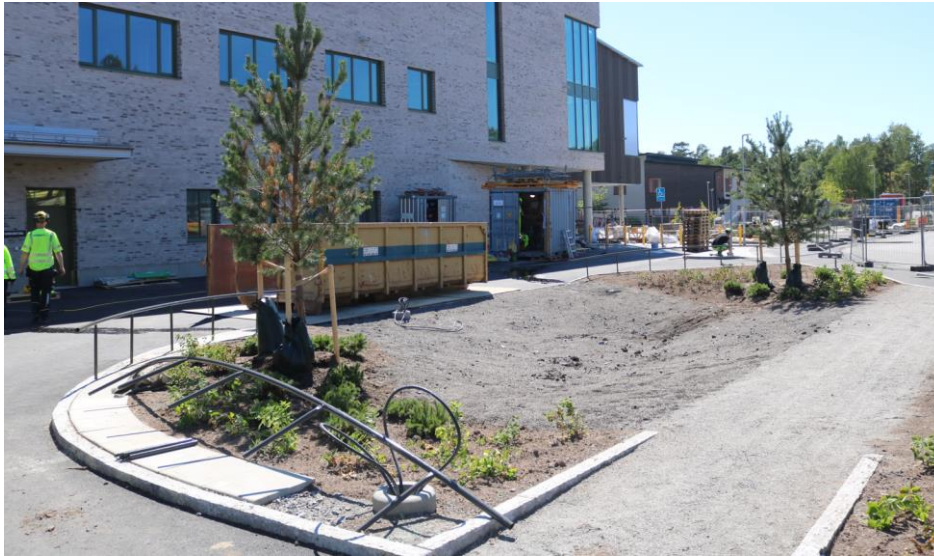
Figur 21. Exempel på nedsänkt växtyta i skolgårdsmiljö. Här utformad som en skålad grönyta utan kantsten på långsidorna, (Gottsundaskolan, Funkia)
