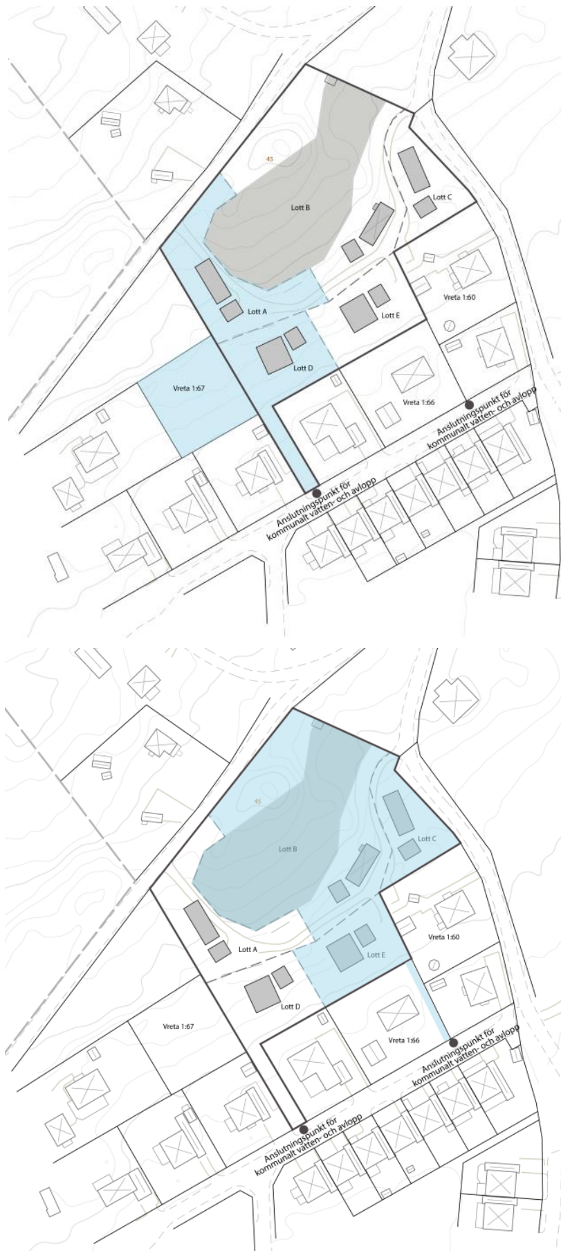
Figur 16. Förslag för utbredning av två gemensambetsanläggningar för vatten- och avlopp.
