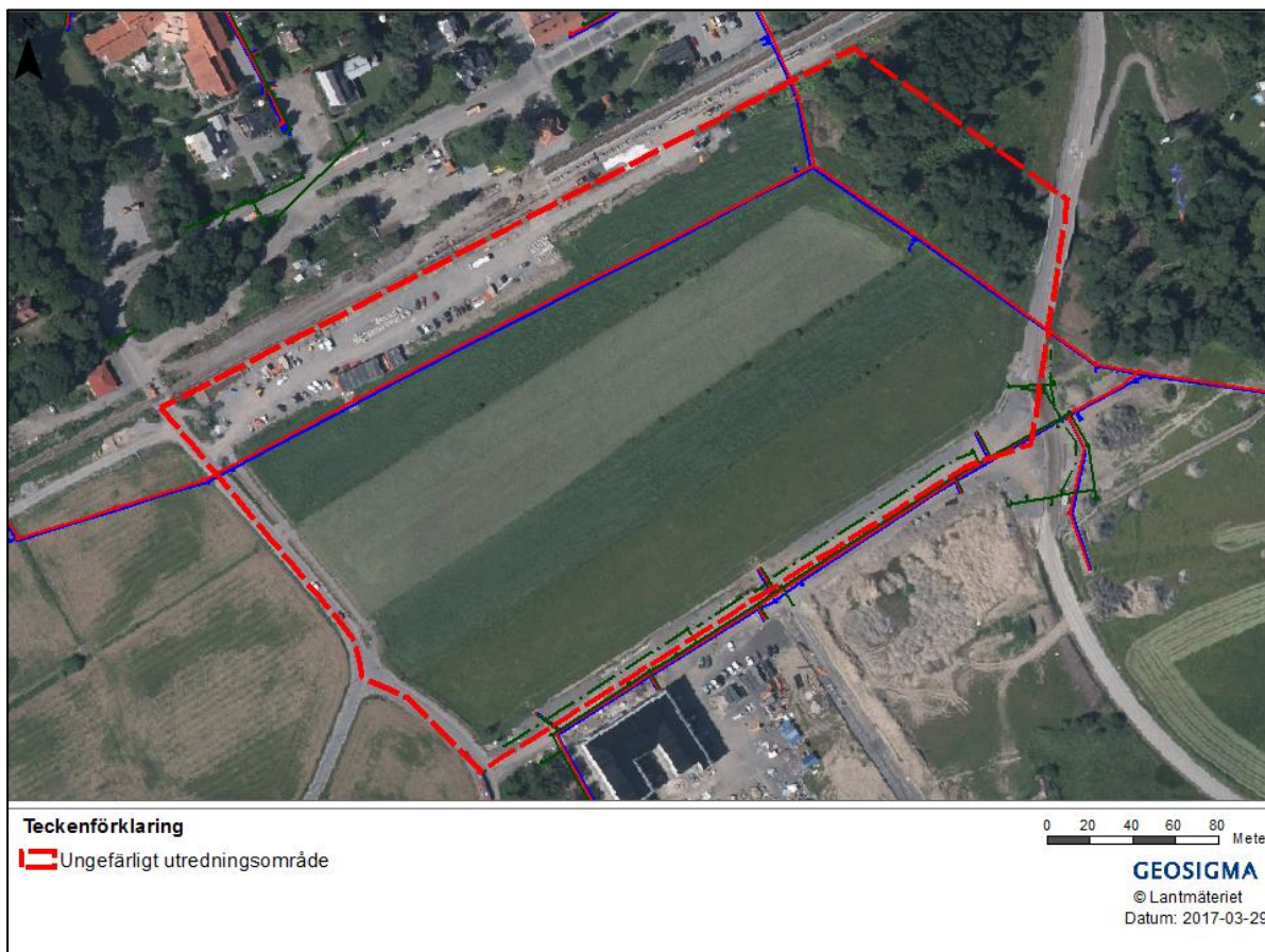
Figur 3-5. Befintliga dagvattenledningar inom utredningsområdet.
