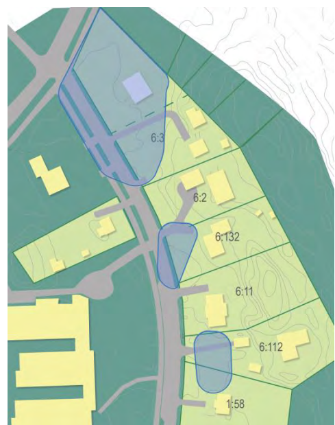
Områden med förhöjd översvämningsrisk som kräver extra hänsyn vid placering och utformning av byggnader är markerade med blått.
