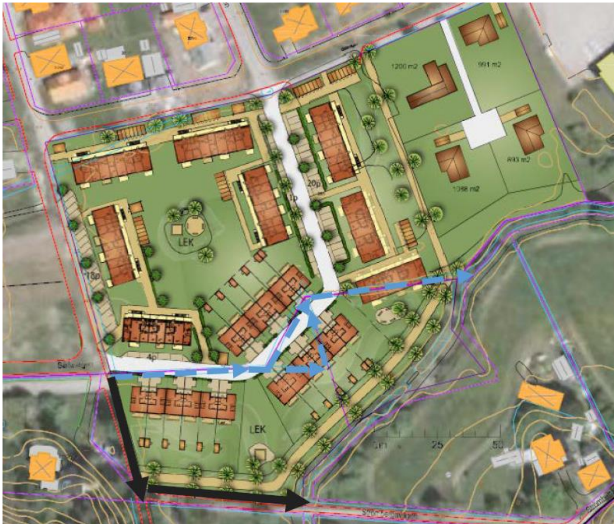
Principlösning för omdirigering av befintliga diken genom planområdet. Blå streckad linje visar befintligt läge, svarta pilar visar omdirigering på naturmark 18 .
