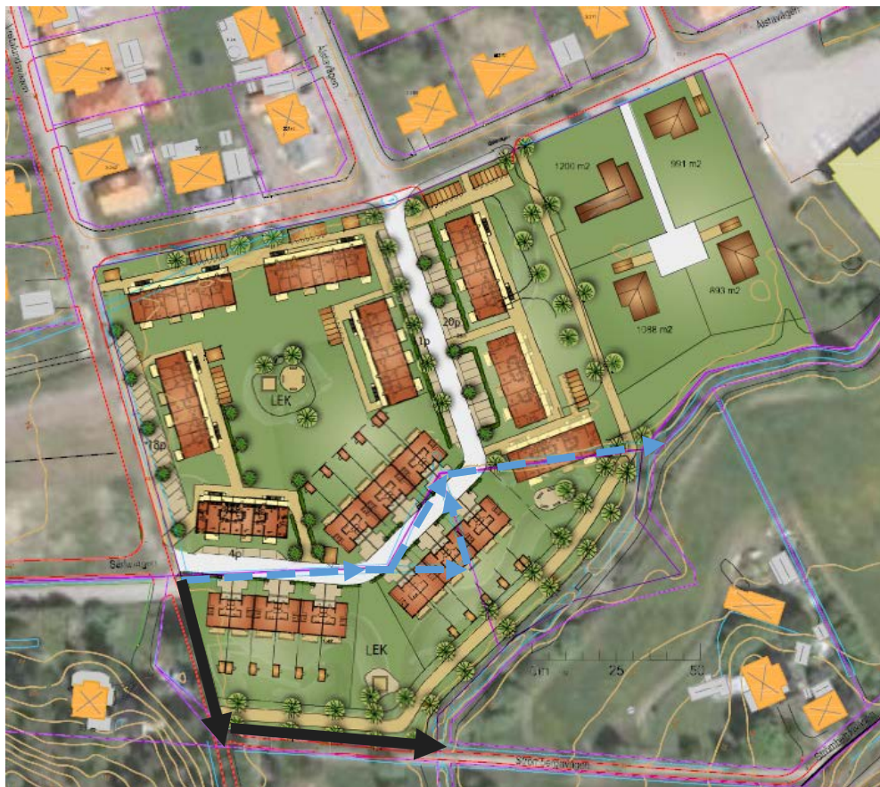
Figur 6. Blåa pilar visar dikessträckningen idag. Svarta pilar visar föreslagen omdragning av diket. Avledning sker till Rocklösaån i båda fallen.
