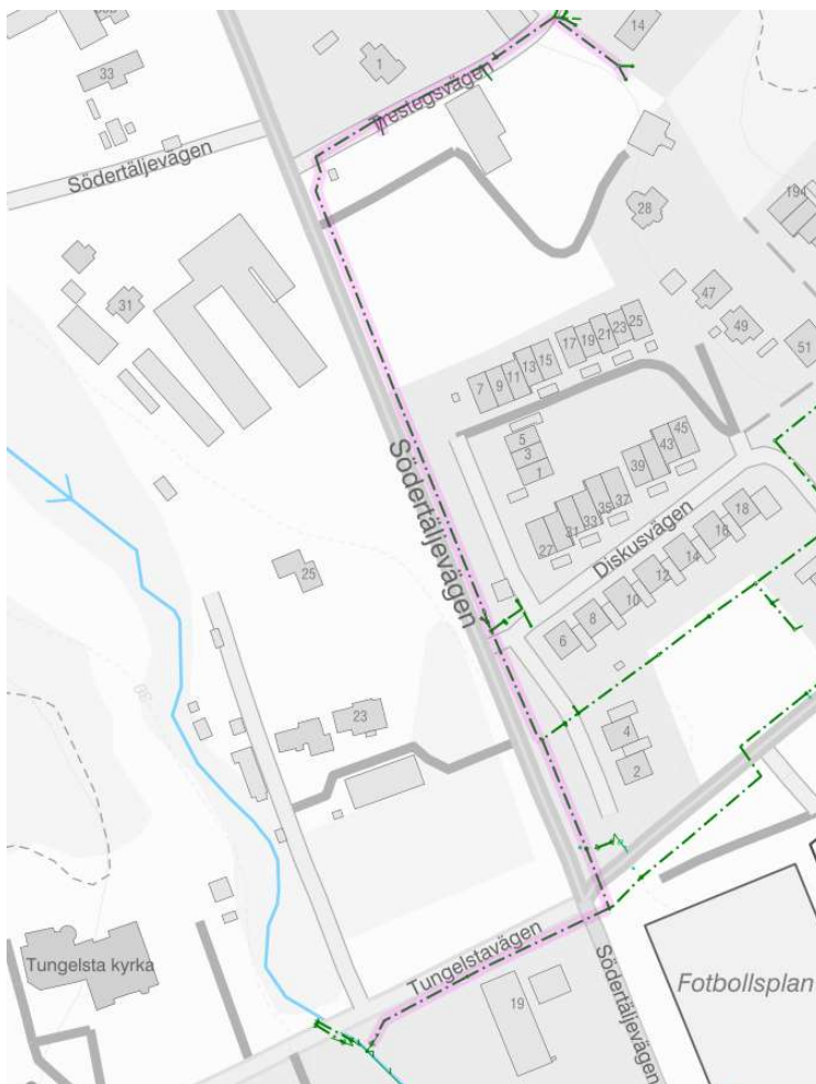
Figur 6. Översikt över dagvattensystemet där dagvattnet avleds söderut till utsläppspunkt i Vitsån-Rocklösaån.
