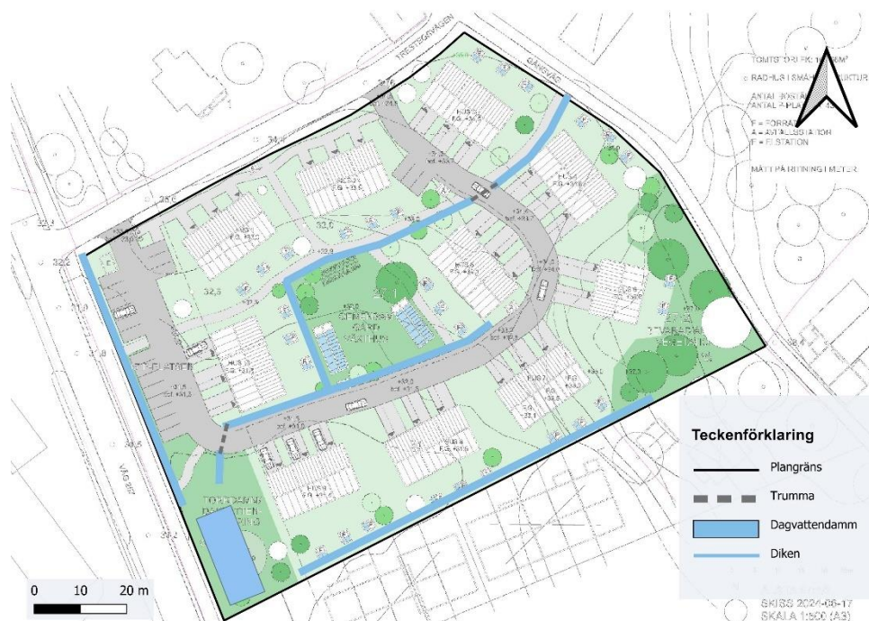
Figur 7-2. Skiss av föreslagen lokalisering av dagvattenåtgärder i planområdet. Detta är inte en exakt utformning eller placering utan en ungefärlig placering.
