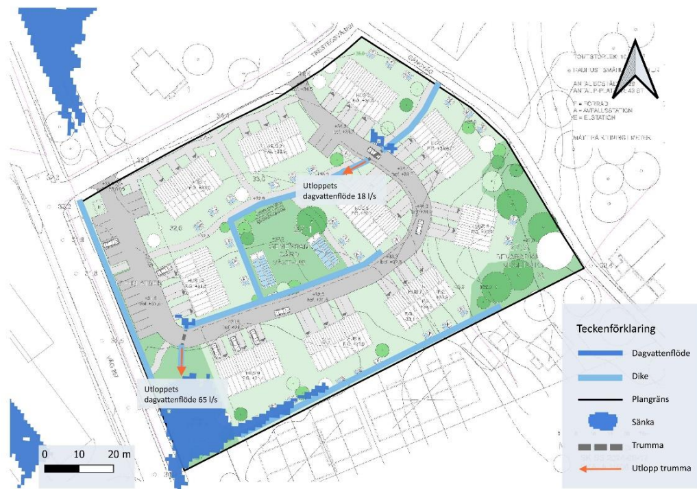
Figur 7-6. Skiss över möjlig placering av två trummor och deras utflöde vid ett 20-årsregn, modellerat med dagvatten för alla delavrinningsområden inom planområdet. Sänka i mörkblått visualiserar vart nederbördens preferens att samlas.
