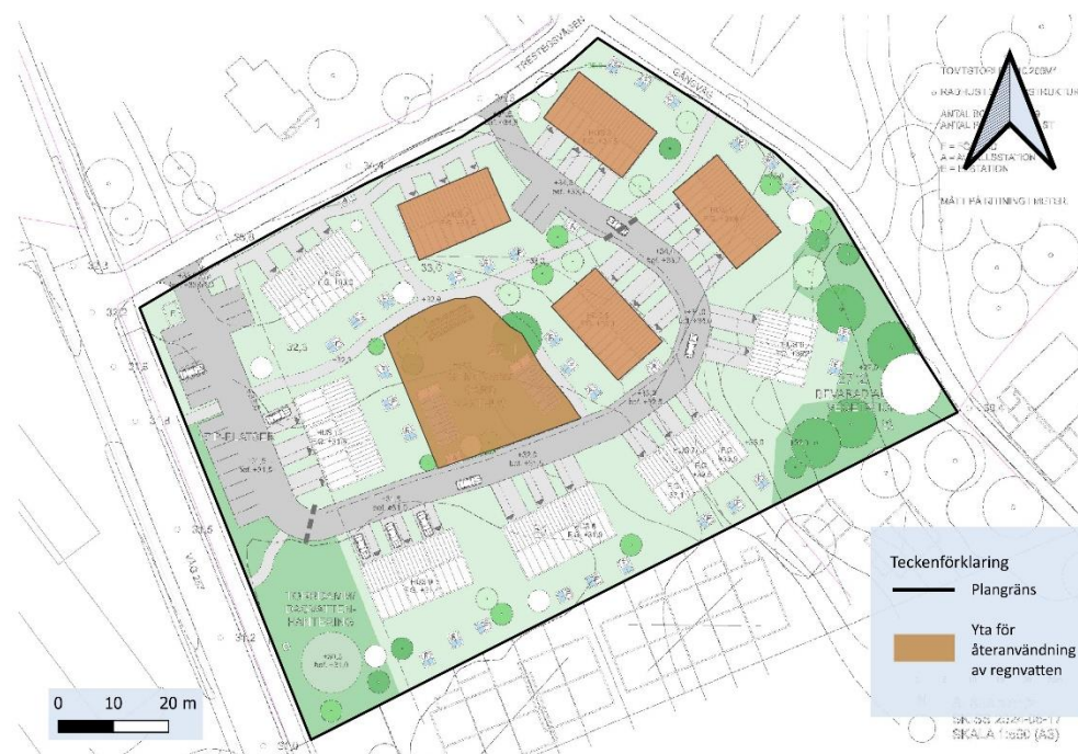
Figur 9-1. Föreslagna ytor för återanvändning av regnvatten.
