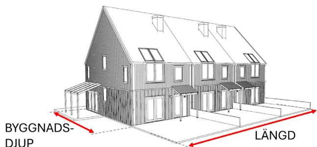
Figur 5. Byggnadsdjup för radhus/parhus är maximalt 10,5 meter, ovan illustration avser radhus. (Arkitekt Johan Kristiansen AB)
