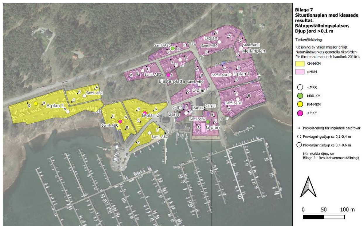
Figur 15. Situationsplan samt resultat för markprovtagning. I yttliga massor (<0,1m) har föroreningshalter över MKM påträffats i hela den östra delen av planområdet (rosamarkerat). Inom tre delområden har föroreningshalter som överskrider riktvärden för MKM påträffats vid provtagningsdjup 0,1-0,4 m (Bjerkning, 2024).
