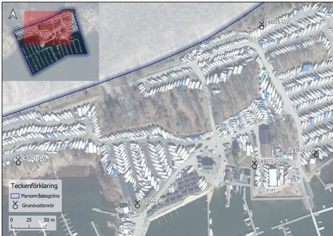
Figur 6. Fem grundvattenrör, 24B01-GV, 24B02-GV, 24B03-GV, 24B04-GV och 24B05-GV, installerades inom planområdet för den miljötekniska markundersökningen utförd av Bjerking under 2024. Ortofoto producerat av Lantmäteriet 2023-05-10.
