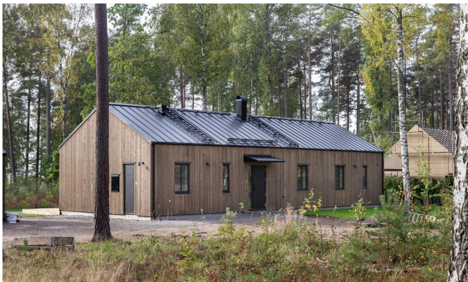
Bild 21–22. Referens tillkommande byggnation. byggrätt som motsvarar detaljplanens byggrätt med stående träpanel behandlad med järnvitrol. Källa: Intressanta hus
