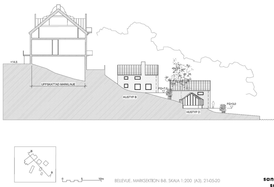
Figur 9. Sektion B-B visar hur tillkommande bebyggelse förhåller sig till hotellet utifrån ett på fastigheten centralt snitt.
