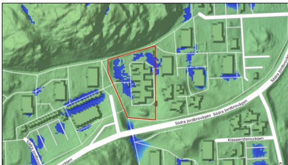
Figur 6:1. Beskrivning av översvämningsområdena på planområdet vid ett 42-millimetersregn, enligt simuleringsprogrammet Scalgo live. Planområdets avgränsning i rött.
