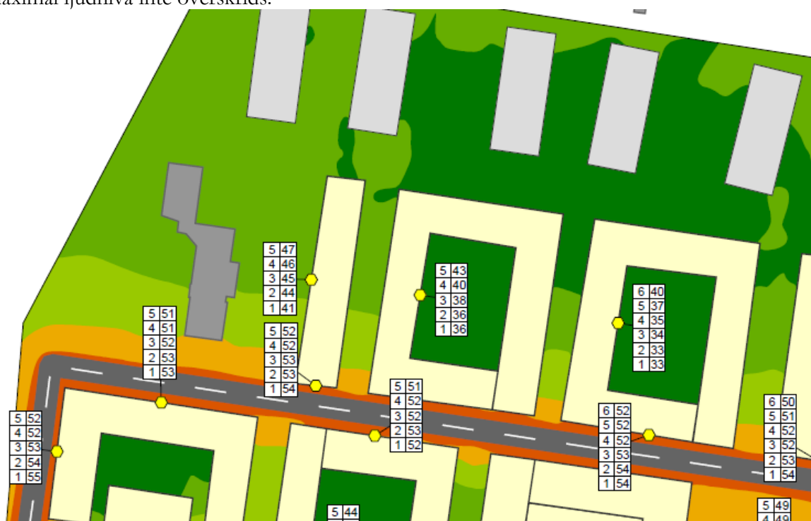
Figur 22. Ekvivalent ljudnivå vid fasad på planerad bebyggelse längs den nya lokalgatan (Norconsult AB, 2017).
