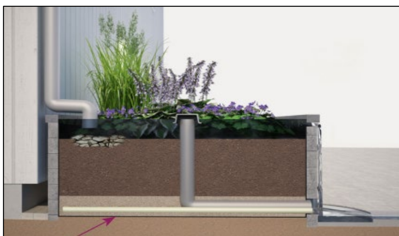
Figur 30. Principskiss över en växtbädds funktion i profil. Växtbädd "typ 4" med tät duk. Används lämpligen för att undvika perkolation. Bildkälla: Movium 2, 2015, illustration: Tengbomgruppen.
