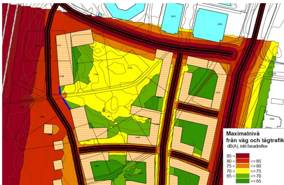
Figur 14. Maximal bullernivå från väg- och tågtrafik två meter över mark med fem meter höga skärmar.
