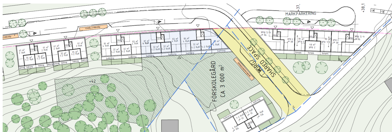
Figur 43 Illustrationsplan som visar planlösningar längs med Nynäsbanan som möjliggör för genomgående lägenheter med hälften av rummen vända mot ljuddämpad sida samt lägenheter mindre än 35 kvadrat (södra delen av planområdet).
