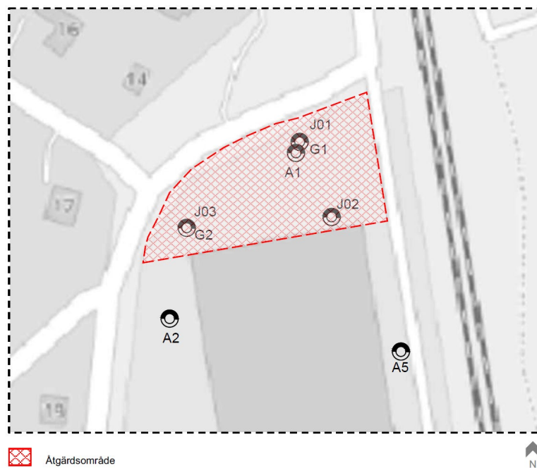
Figur 15 Föreslaget efterbehandlingsområde för schaktning och bortförsel av förorenade massor, följt av kontrollprovtagning för avgränsning av föroreningen (Geoveta, 2019).
