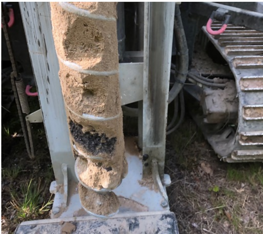
Bild från skruprovtagning av jord i punkt J01 som visar förorenat mörkt lager.
