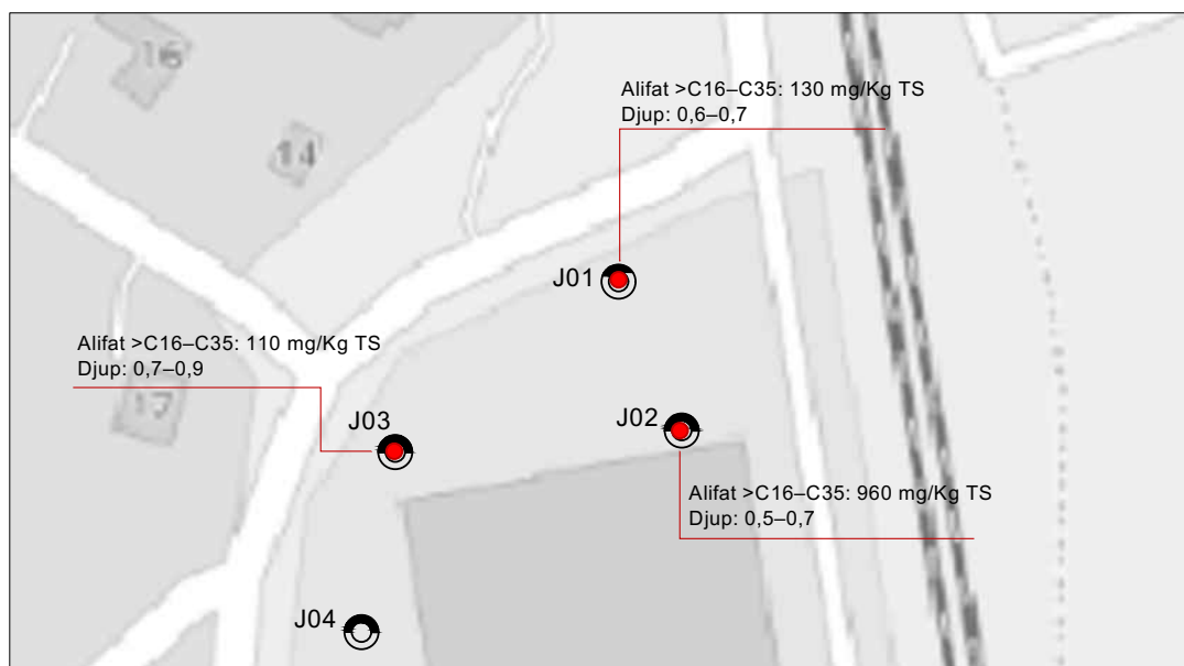
Figur 1. Figuren visar de punkter där föroreningar över KM påträffats, markerade med röd färg. Halt och djup för förekomsten redogörs också för i bilden. Riktvärde för KM är 100 mg/kg TS. Norr är uppåt i bild.
