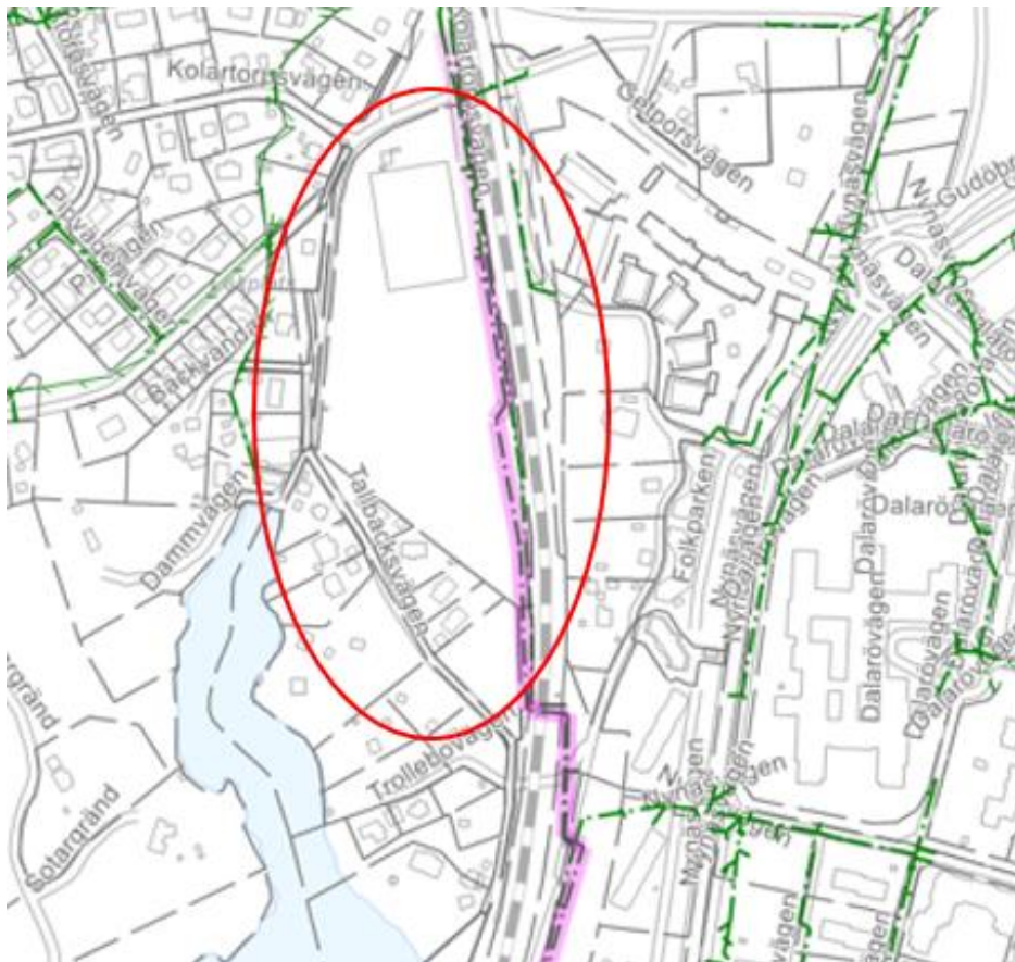
Figur 8. Dagvattenledning som passerar planområdet (grön streckad linje med rosa markering). Där den passerar planområdet är den 600 mm betong. Planområdets ungefärliga placering visas i rött.
