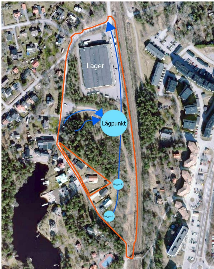
Figur 3. Flygfoto över planområdet (röd linje) som visar lagerbyggnad i norra delen och åsen i mittersta delen, samt befintliga lågpunkter (blåa cirklar) och ungefärliga flödesvägar inom området (blåa pilar).
