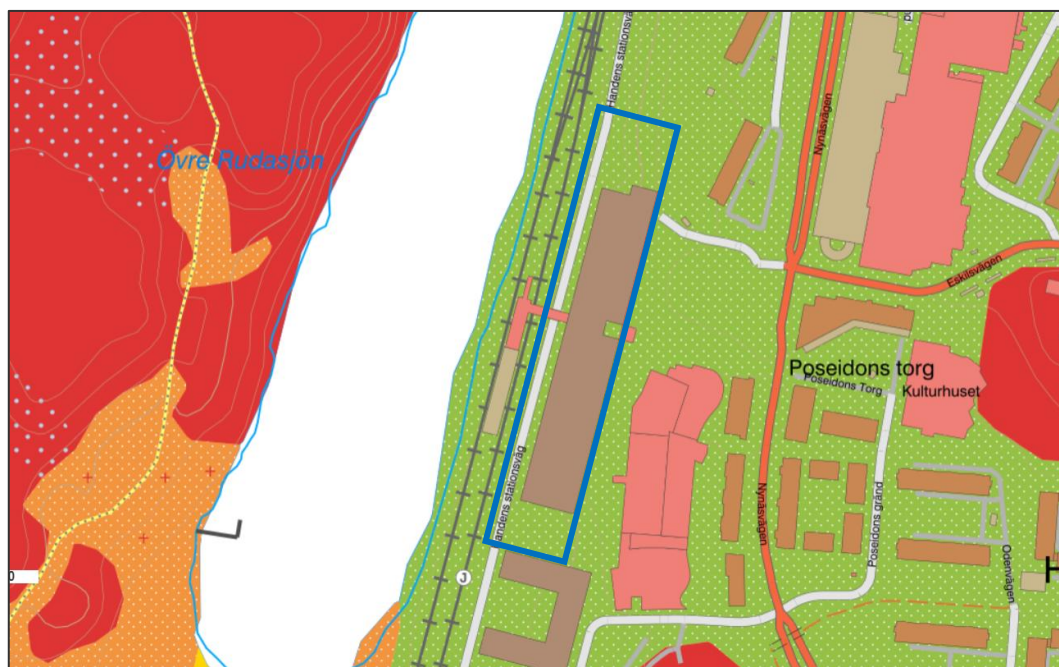
Figur 3. Jordartskarta över undersökningsområdet. Grönt=issälvsediment av sand. Orange=postglacial sand, rött=urberg, blå prickar ovanpå rött= tunt lager morän ovanpå urberg. Undersökningsområdet ungefärligt markerat med blått. Källa: SGU:s kartvisare.
