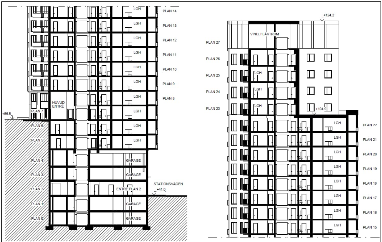
Figur 5. Sektionsritning över punkthuset.
