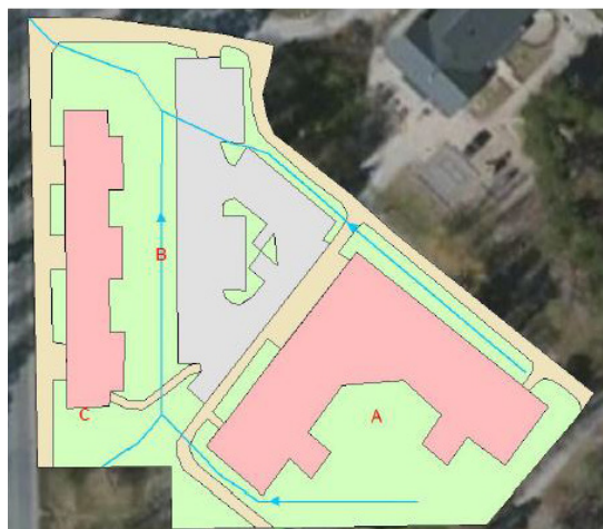
Schematisk höjdsättning av avrinningsstråk (Dagvattenutredning - Söderby 2:27 och Söderby huvudgård 4:315, 2017-03-07, WSP)
