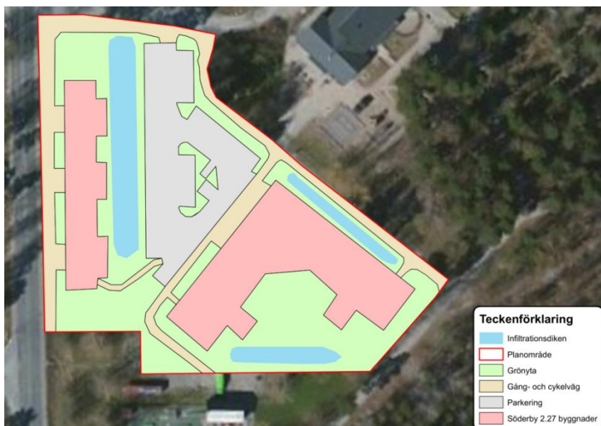
Figur 12. Exempel på möjliga ytor för infiltrationsdiken
