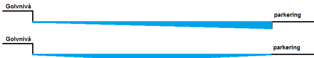
Figur 18. Möjlig utformning av översvämningssytor vid punkt B.
