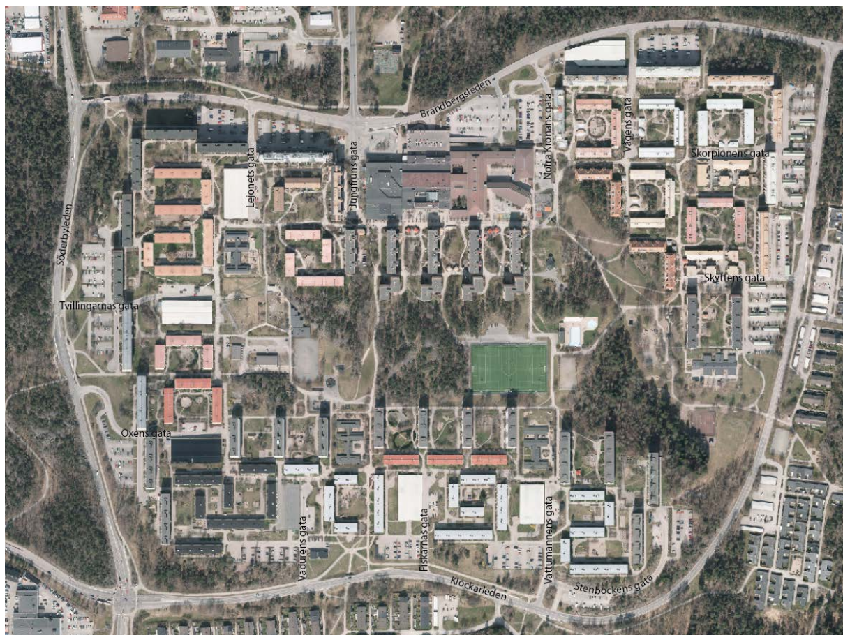
Bild 9: Fotot visar gatunätet i Brandbergen och hur säckgator leder in i området via tre huvudgator. Inne i området finns det en rad olika gång- och cykelvägar.
