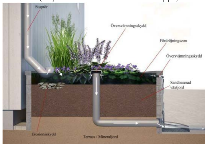
Bild 43: Exempel på hur en växtbädd eller regnträdgård kan konstrueras. Bildkälla: Grågröna systemlösningar för hållbara städer, Inventering av dagvattenlösningar för urbana miljöer, Vinnova 2014
