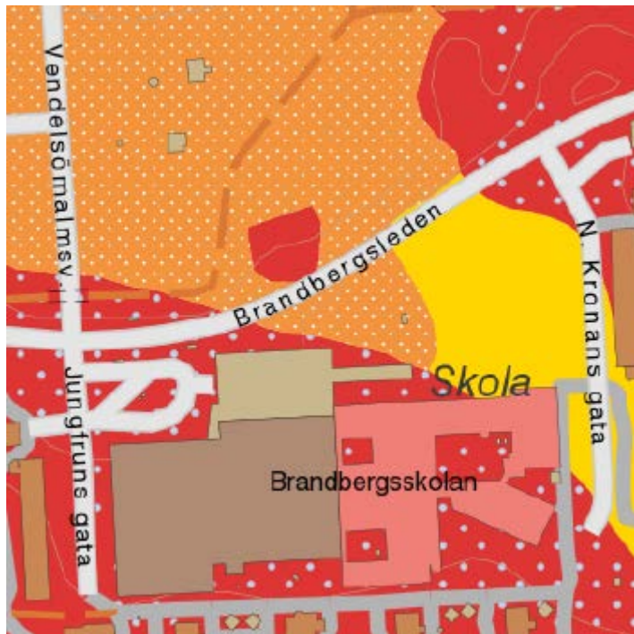
Bild 14: Gult lager visar glacial lera, orange med vita prickar visar postglacial sand och rött med blå prickar visar morän på berggåll.
