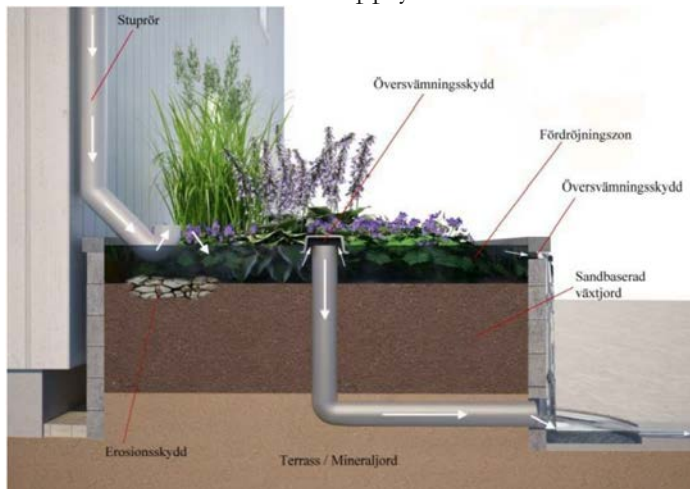
Bild 44: Exempel på hur en växtbädd eller regnträdgård kan konstrueras. Bildkälla: Grågröna systemlösningar för hållbara städer, Inventering av dagvattenlösningar för urbana miljöer, Vinnova 2014
