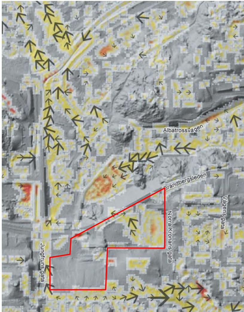
Figur 5 Illustration över flödesdjup som uppstår vid ett dimensionerande regn med återkomsttid 100 år (Structor)
